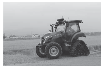
デモンストレーションで自動運転技術により無人走行するトラクター
